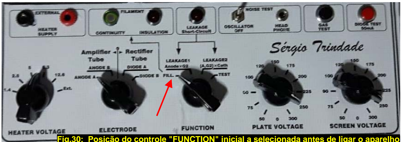
Fig.30: Posição do controle "FUNCTION" inicial selecionada antes de ligar o aparelho
